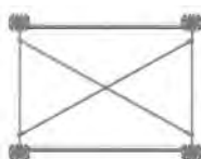
Turn 1,5x2,0 m, vedere de sus Bară transversală orizontală 1,2x2,0
